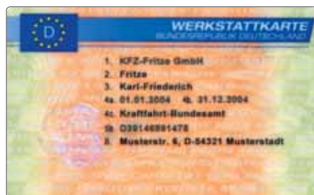
Scheda officina: Identifica l'officina autorizzata, mette il tachigrafo digitale in modalità di taratura e permette di fare lo scarico dei dati.
